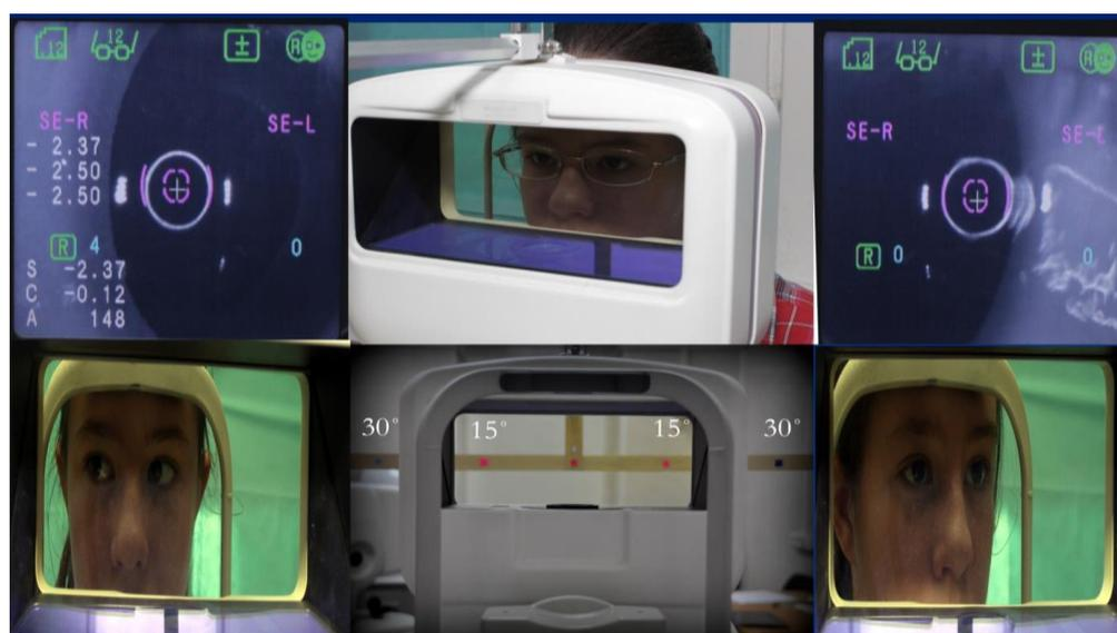
Рис.1. Измерение периферической рефракции на бинокулярном авторефрактометре «открытого поля» Grand Seiko WR-5100K (Япония)
